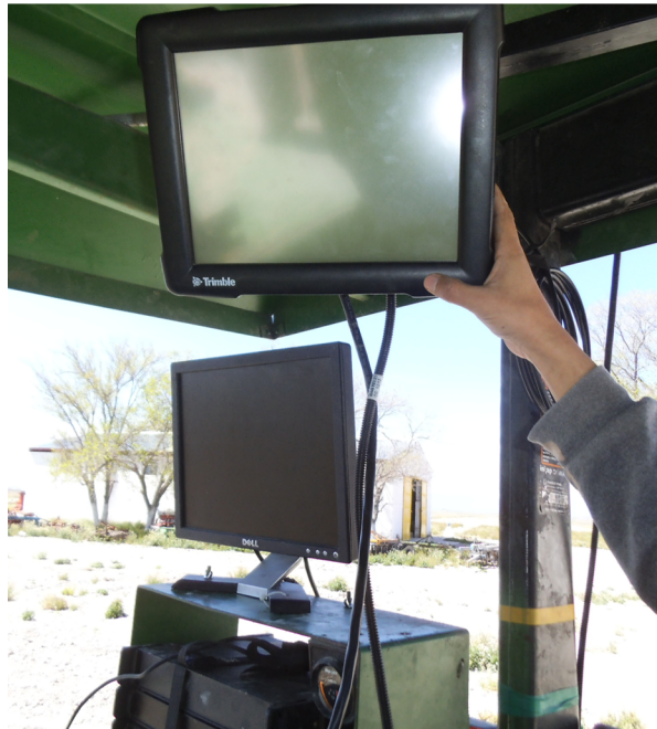
Figura 3.13: Pantalla FmX montada en el tractor
