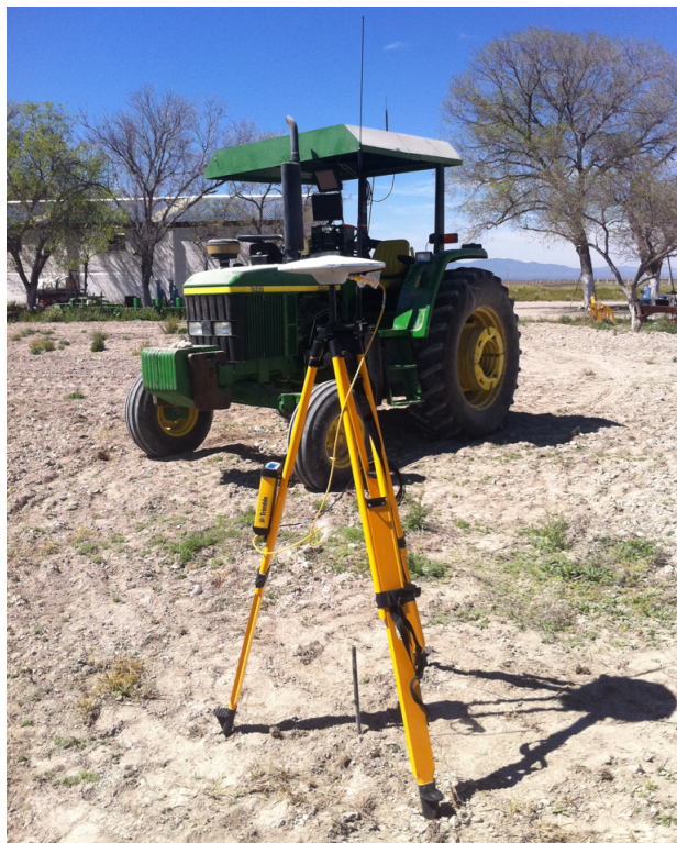
Figura 3.14: Estación base RTK en campo
