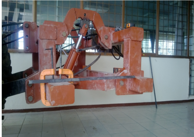
Figura 3.4: Pruebas de movilidad del arado articulado
