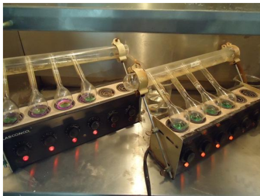
Figura 42. Muestra aclarada y en ebullición por una hora.
