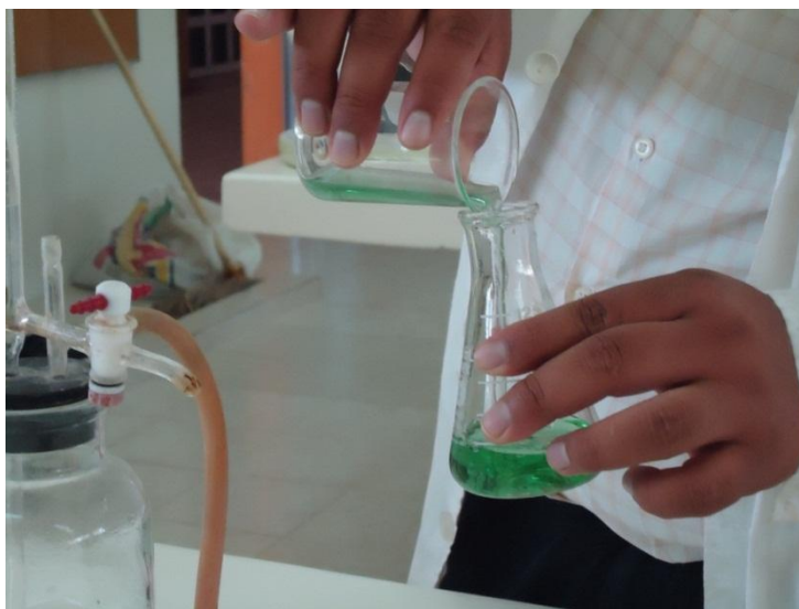
Figura 44. Pasando la muestra destilada del vaso de precipitado al matraz.
