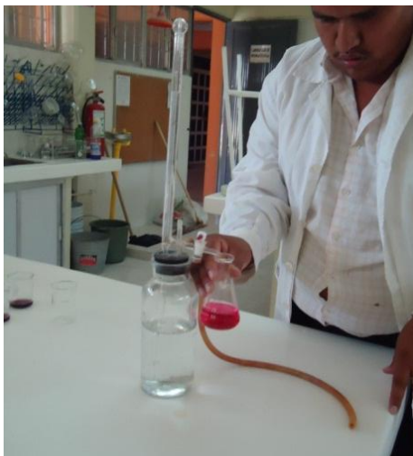
Figura 46. Logrado el punto de equivalencia ya que la muestra pasó de verde a rosa.
