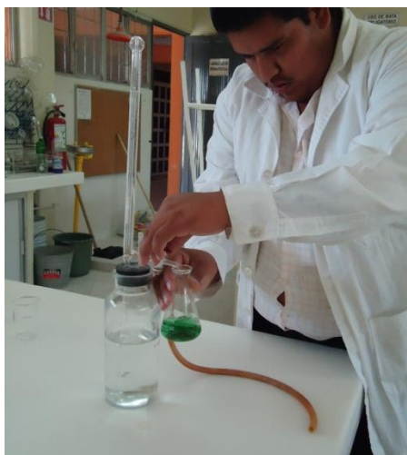
Figura 45. Agregando ácido sulfúrico 0.05 N con una microbureta de 10 ml con graduaciones de 0.02 ml.
