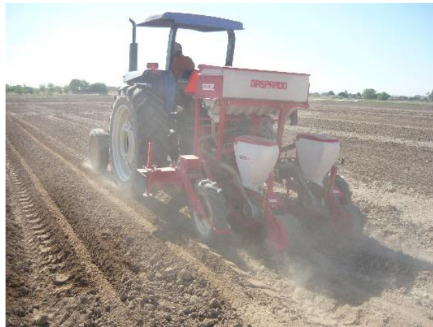
Figura 1. Siembra del algodón con una sembradora de precisión tipo Gaspardo, en instalaciones del INIFAP-Campo Experimental La Laguna.
