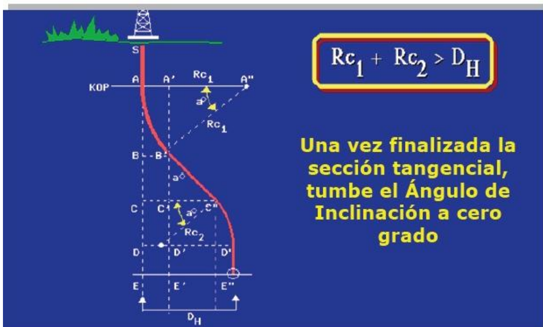
Figura 3.3 Pozo tipo “S”
