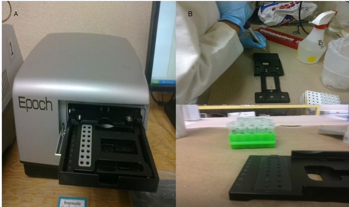
Figura 4 Cuantificación de ADN A) Epoch Microplate Spectrophotometer™ con la placa Take3™; B) Take3™ cargada con ADN.
