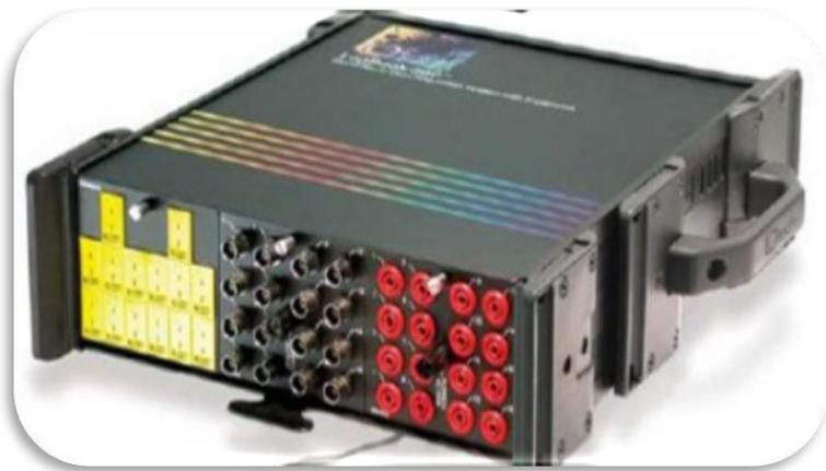
**Figura 2.17** Sistema de adquisición de datos LogBook 360
