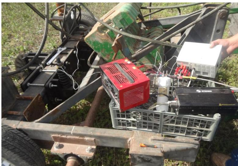
**Figura 4.11** Montaje del sensor de humedad al carro-portasensores
