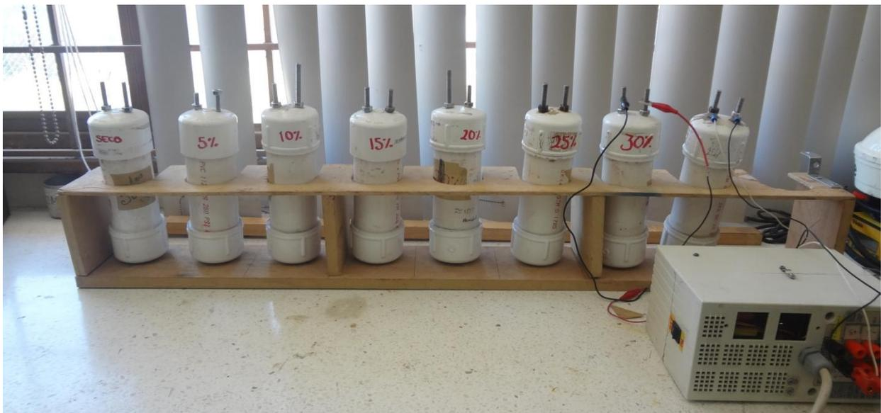
**Figura 4.5** Probetas a diferentes porcentajes de humedad
