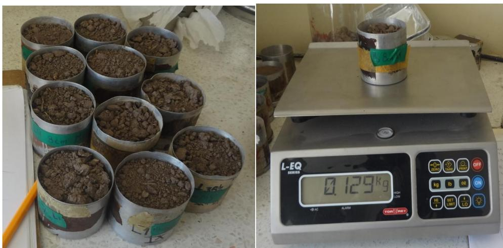
Figura 4.4 Obtención del peso de humedad
