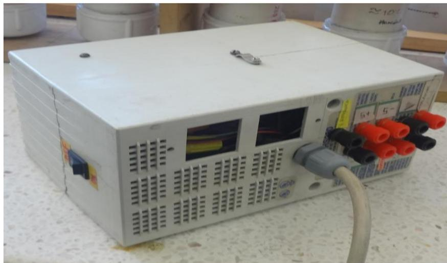
**Figura 4.2** Modulo integrado por los circuitos integrados para el acondicionamiento de la señal proveniente de los discos
