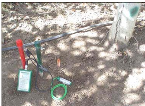
Figura 3.7.6. a) Sensor de humedad instalado, en el área de influencia del emisor a diferentes profundidades. Verde: a 30 cm.; rojo: a 60 cm.
