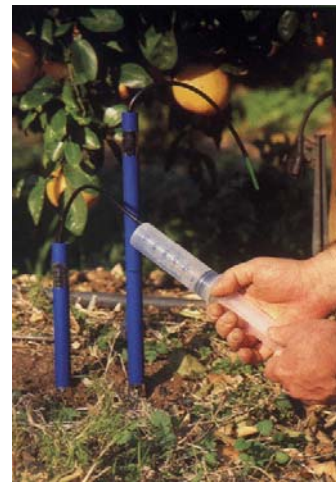
Figura 3.8.7. Sondas de extracción o lisímetros de succión instalados a diferentes profundidades.
