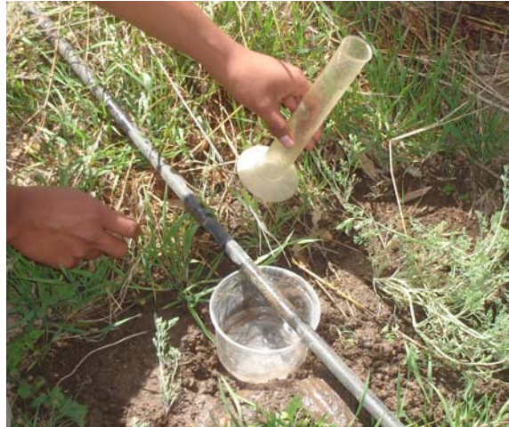
Figura 3.7.8. Medición del caudal en los puntos de evaluación.
