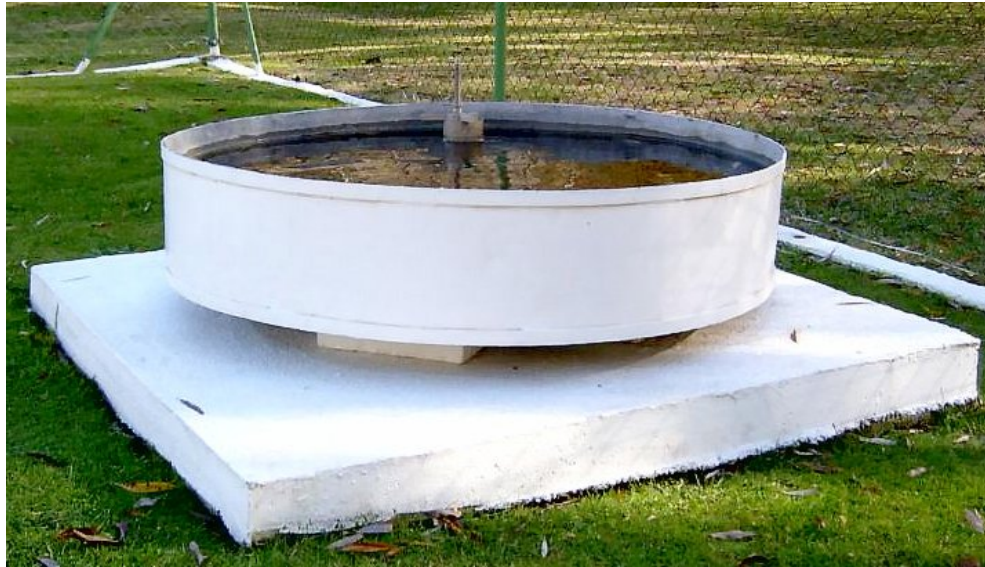
Figura 3.7.1. Tanque evaporímetro tipo A, el método mas usado para determinar Eto.
