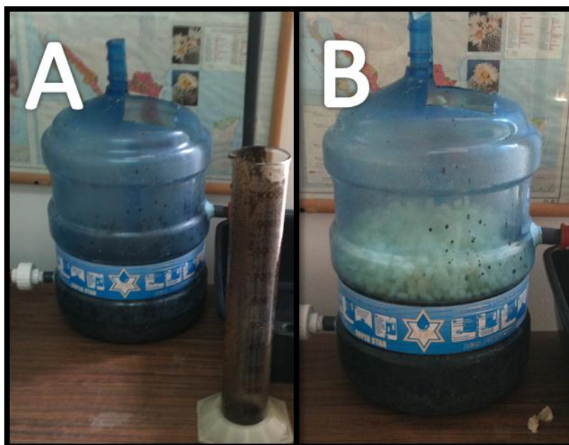
Figura 5.2. A) Incorporación de la esponja de poliuretano B) Incorporación del agua residual y el soporte de esponja
