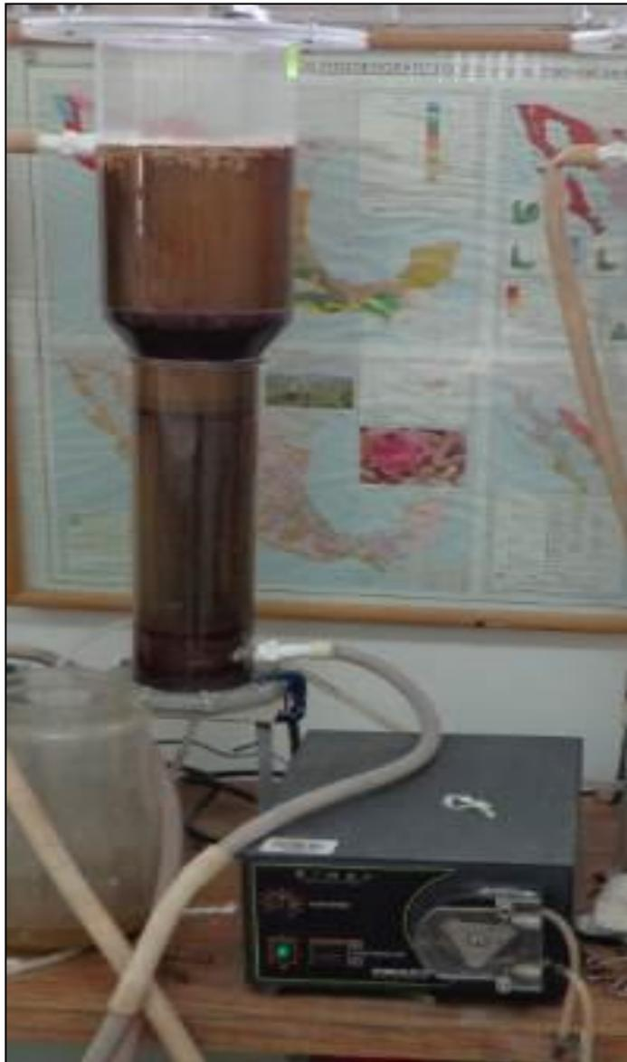
**Figura 7. Reactor filtro anaerobio, con exceso de residuos. Antes de lavado.**
