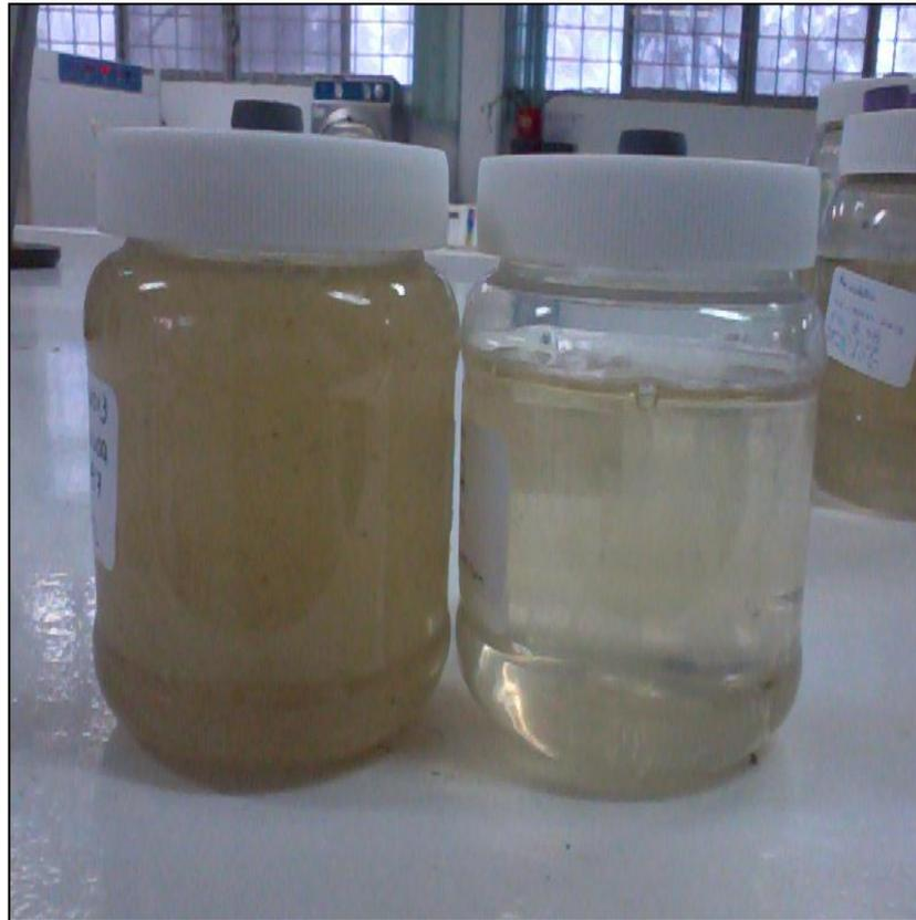
**Figura 11. Toma de muestra de agua cruda (Izquierdo), toma de muestra de reactor anaerobio (Derecho). Después de lavado**
