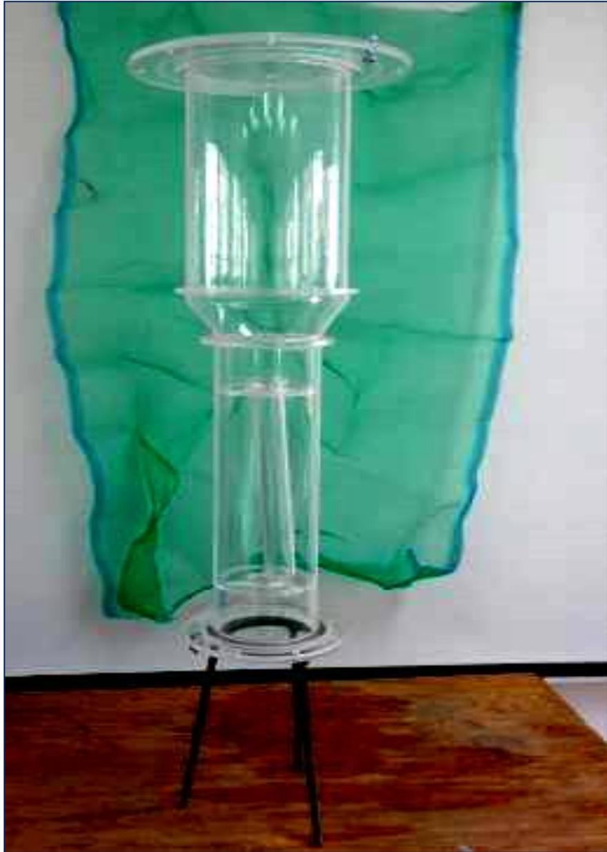
**Figura 4. Reactor de Filtro Anaerobio de acrílico**
