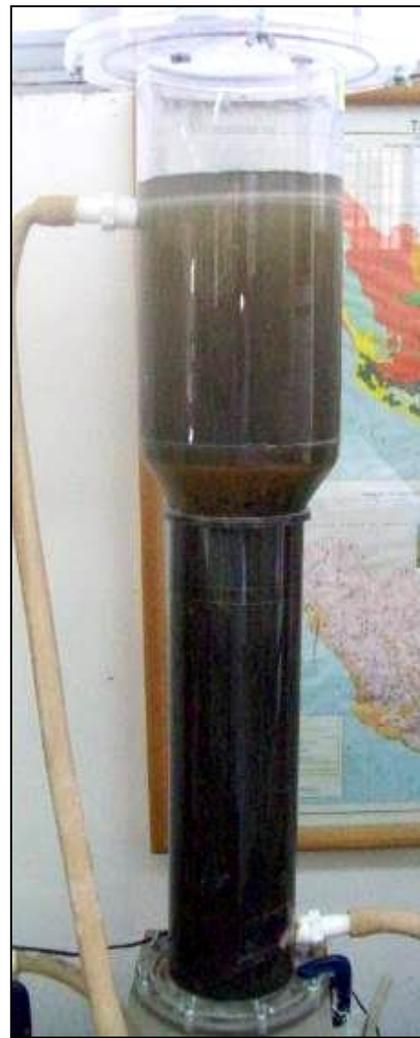
**Figura 9. Reactor con Lodo Anaerobio**
