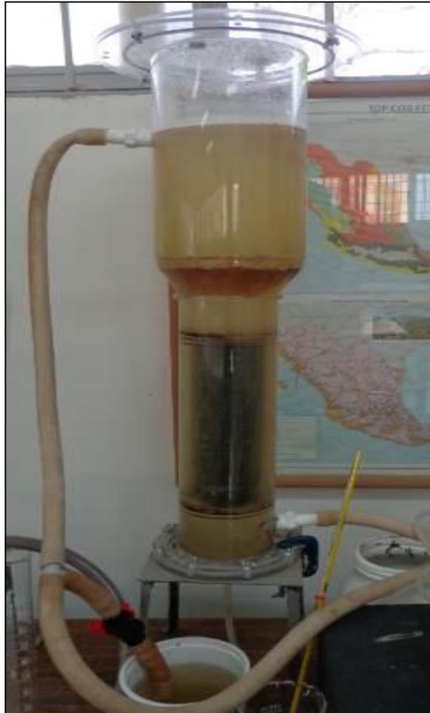
**Figura 10. Reactor de filtro anaerobio después de lavado**
