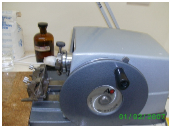
Figura10. Micrótopo rotatorio utilizado para obtener los cortes transversales de Ceratonia siliqua L.
