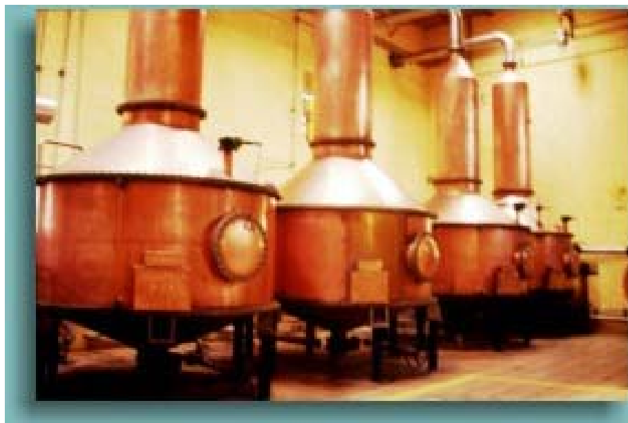
Figura No. 25 Destilación del mosto en alambiques de cobre
