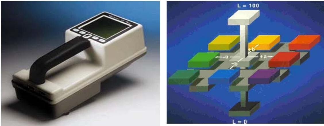
Figura 1. Colorímetro Portátil Miniscan (a) y escala de colores de las determinaciones (b).
