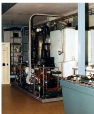
FIGURA 7: Liofilizadora industrial de tamaño grande con un ambiente controlado “Cortesía de Ghimas SpA” (Krell, 1996).
