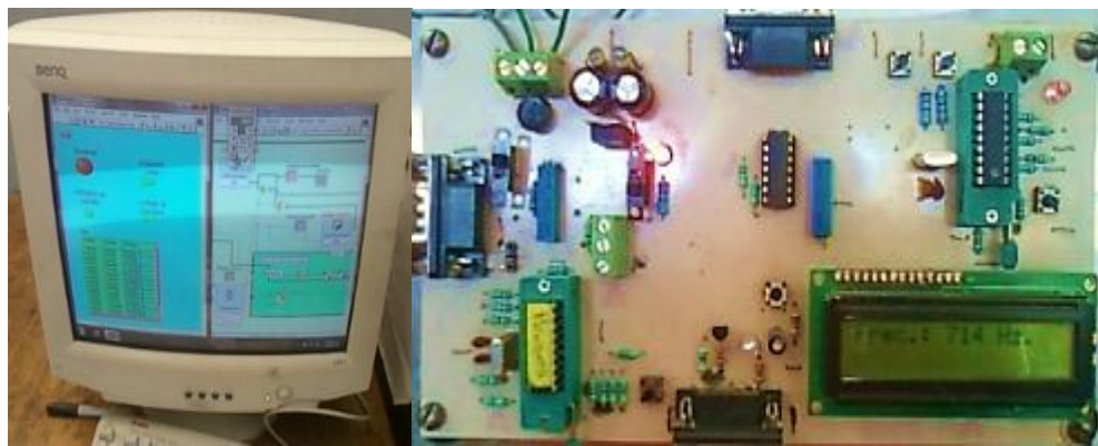
Figura 4.13 Comparación de registro y conteo de datos en el Instrumento virtual y la tarjeta electrónica.
