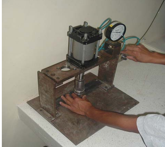
Figura 6.3 Simulación de compactación de muestras de suelo
