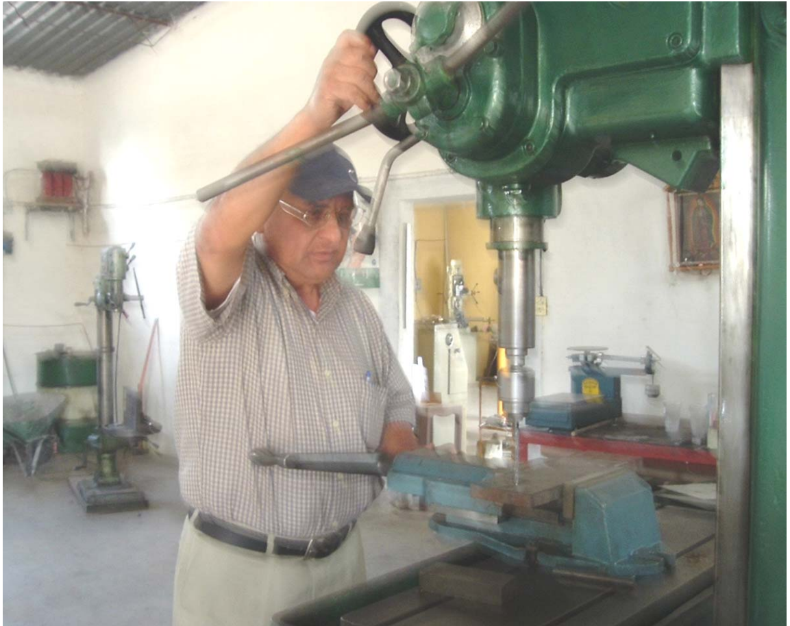
Figura 5.4. Taladrado de orificios en las placas para los tornillos.
