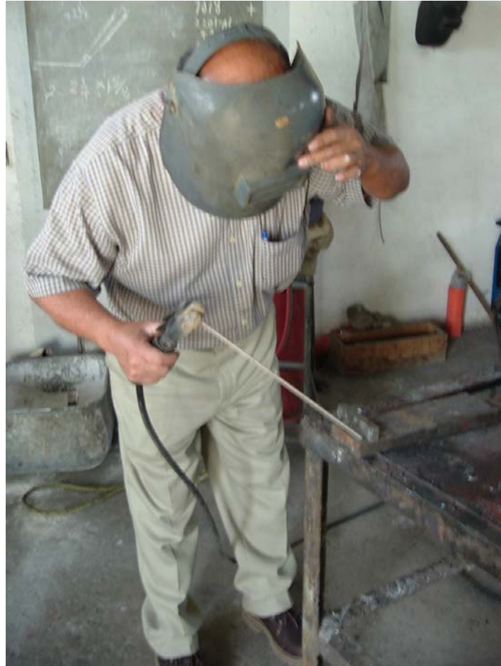
Figura 5.5 Proceso de soldeo de placas
