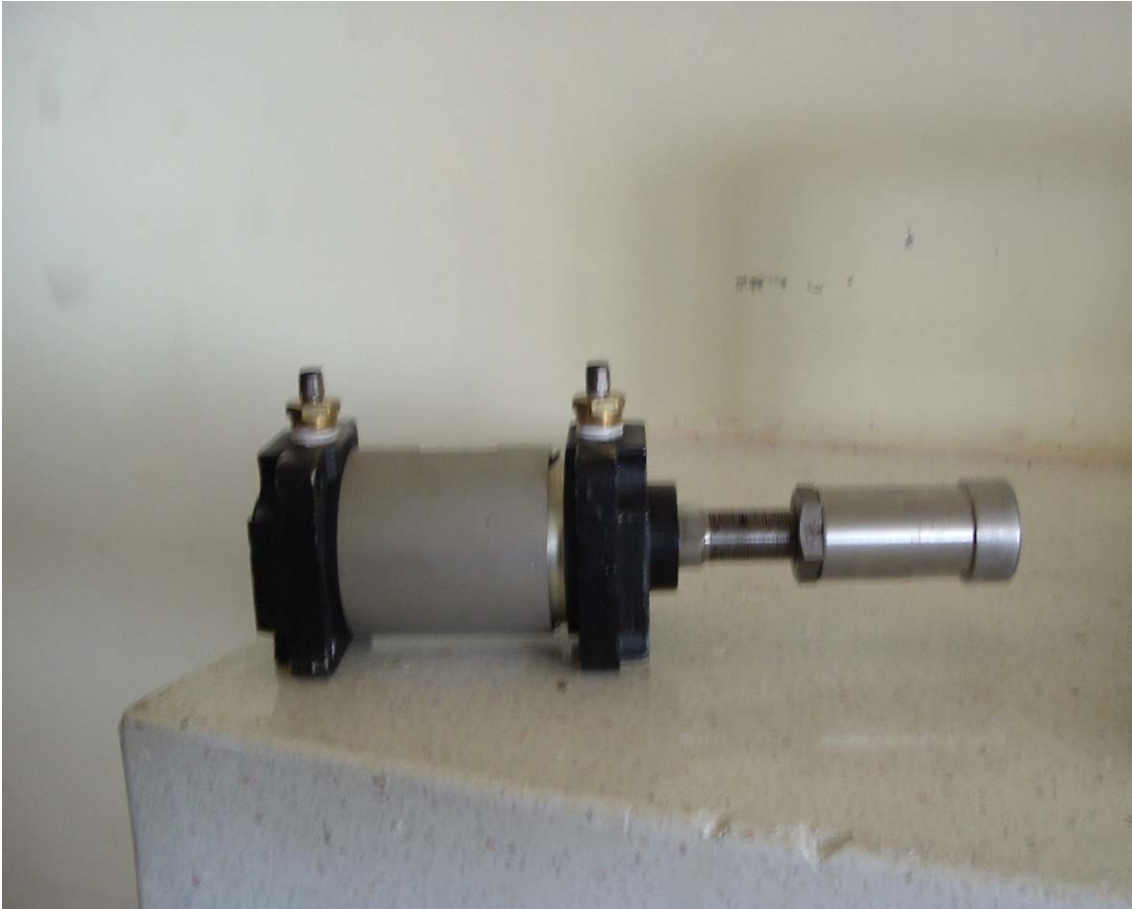
Figura 5.11 Pistón acondicionado para ser instalado en la estructura del simulador.
