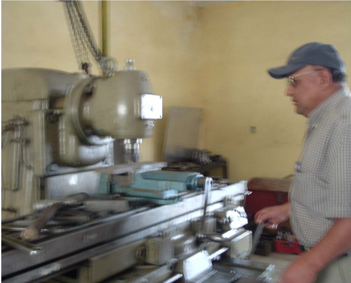
Figura 5.3 Maquinado de la placa de montaje en una fresadora.
