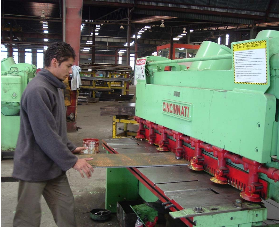
Figura 5.2 Corte de placa con guillotina.
