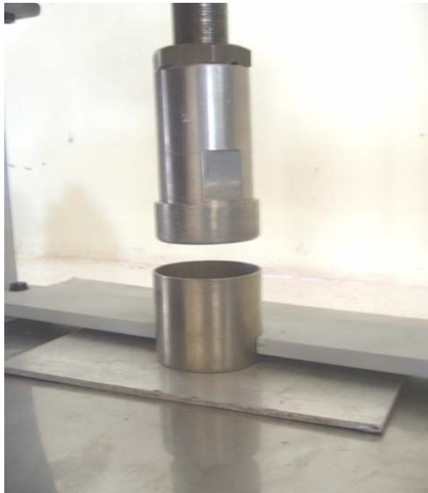
Figura 6.2 Muestra de suelo lista para compactarse.
