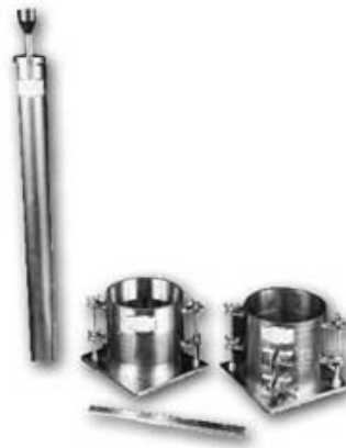
Figura 2.2 Equipo próctor modificado. Molde, Pisón, Guía Regla metálica enrasadora.
