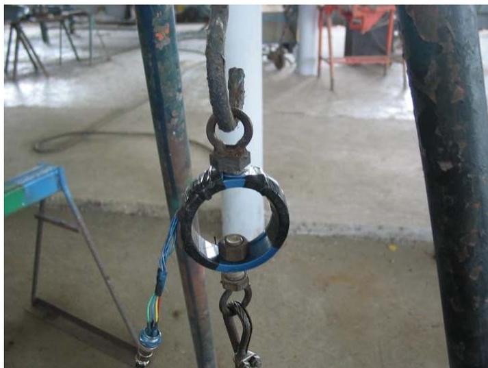
Figura 3.5 Dinamómetro de anillo.
