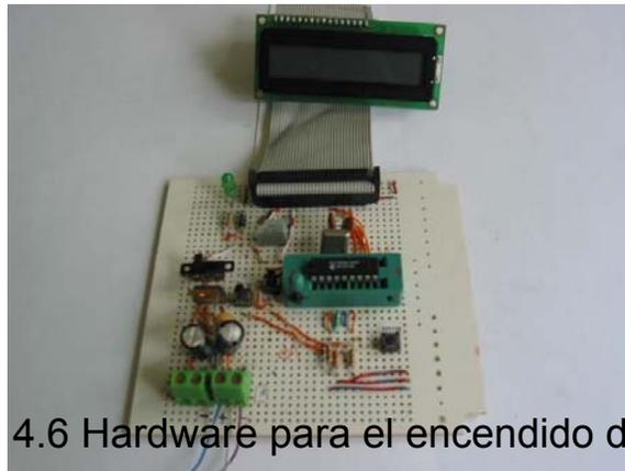
Figura 4.6 Hardware para el encendido de módulo LCD.
