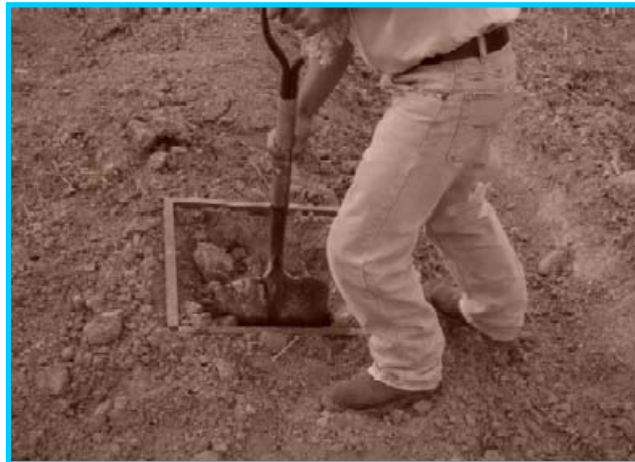
Fig. 3.16 Extracción de muestra de suelo hasta suelo firme.
