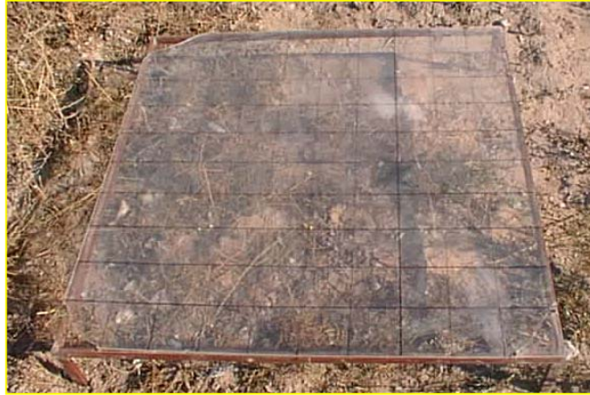
Fig. 3. Aparato para la determinación de cobertura vegetal
