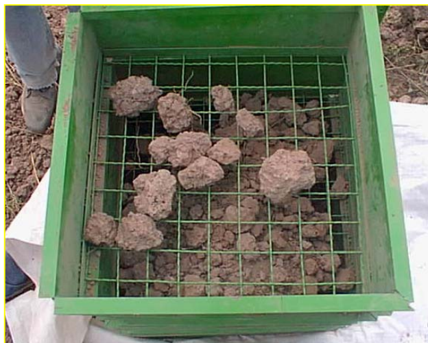
Fig. 11. Cribas para la determinación del tamaño de agregados
