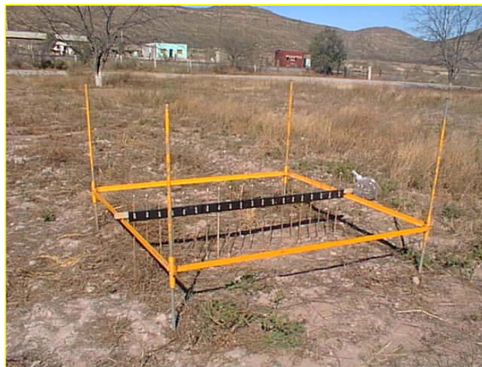
Fig. 4. Aparato para medir el microrrelieve
