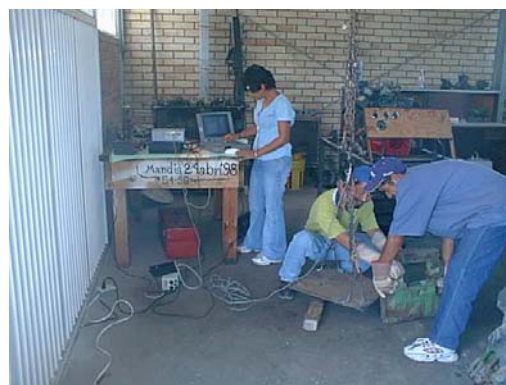
Fig. E.2 .-Colocación de peso para su Calibración.
