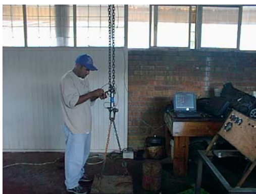
Fig. E.1 .- Colocación del dinamómetro en posición adecuada para posteriormente colocar los pesos (Contra-pesos de tractor)
