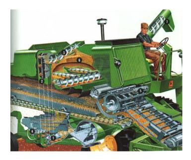
El manejo de la cosecha incluye estos componentes: sinfin inferior del grano limpio; elevador del grano limpio; sinfin de carga del tanque de granos; sinfin inferior de retorno; elevador de retorno (no se muestra); sinfin superior de retorno; tanque de granos; y sinfin de descarga del tanque de granos.
