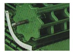
El cóncavo consiste de una serie de barras paralelas de acero mantenidas unidas por barras curvas laterales y varillas. El cóncavo va montado debajo y ligeramente hacia atrás del cilindro. La curvatura del cóncavo generalmente va conformada a la circunferencia exterior del cilindro (FMO, 1973).
