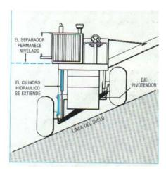
El mecanismo de nivelación automática está formado por una combinación de sistemas de nivel de fluido, eléctrico e hidráulico. El separador es ajustado para
