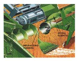
Una vez que la cosecha ha sido cortada, el papalote la emplaza sobre el sinfín, que la desliza hacia el centro de la mesa, donde se encuentran los dedos retráctiles que la colocan en el embocador. El sinfín debe estar como máximo 1/8 de pulgada separado del banco o mesa. Es impulsado de un extremo por medio de una cadena de rodillos y es protegido contra sobrecargas o atracones por un embrague deslizante que patina cuando algún obstáculo detiene su movimiento bruscamente (ACEVEDO LOPEZ, 1976).
