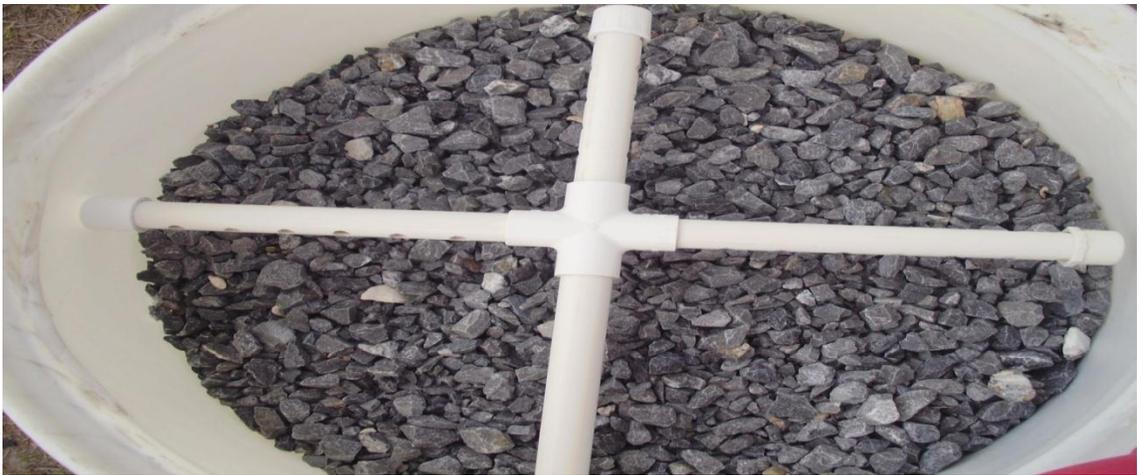
Figura 14. Medio Granular Utilizado
