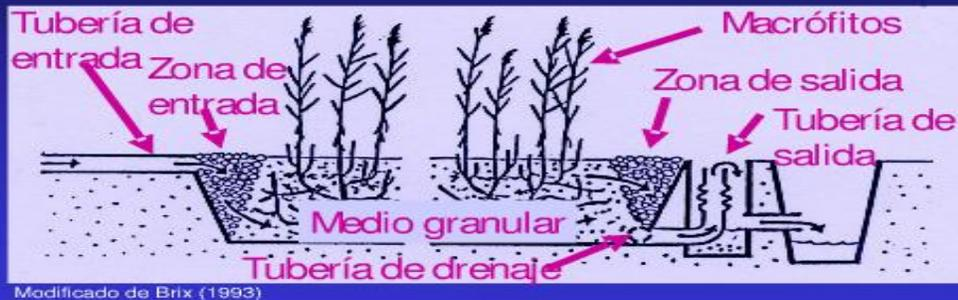
Figura 3. Humedal Artificial de Flujo Subsuperficial (Brix, 1994)
