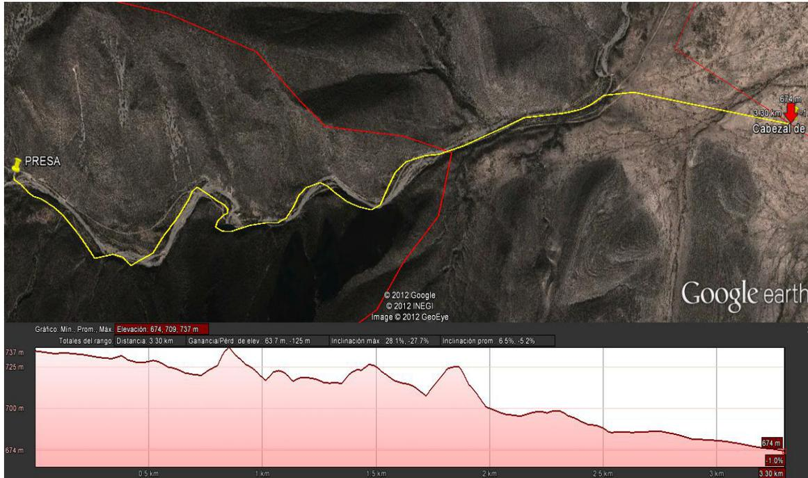
Figura 18. Plano de línea de conducción con su perfil topográfico.
