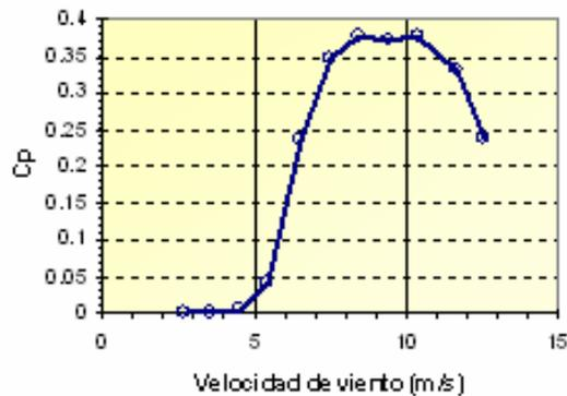
Figura 4.14. Comportamiento del coeficiente de potencia en un rotor eólico
