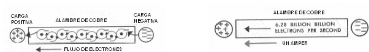
Fig. 3.3 Flujo de electrones en un conductor. FIG. 3.4 Medición de la corriente eléctrica.
