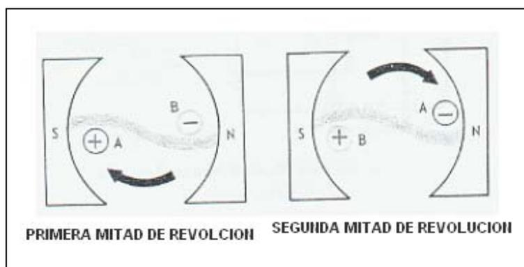
Fig. 3.27 como cambia la polaridad de la armadura durante cada revolución.
