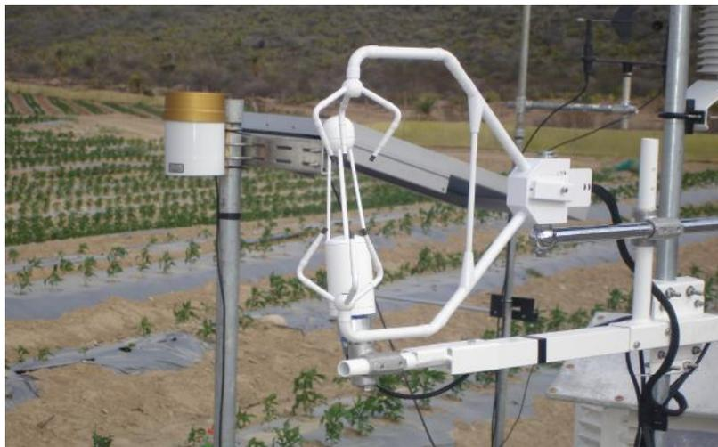
Figura 3.2. Sensores principales de un sistema eddy. 3-D sonic anemometer y CS7500 open path  $\text{CO}_2/\text{H}_2\text{O}$  gas analyzer.
