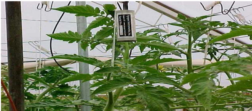
Figura 3.3. Arreglo del Sensor Infrarrojo para medir la Temperatura del follaje de 6 - 8 cm de separación de la hoja en una planta representativa.
