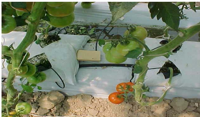
Fig. 3.6 Vista de la posición del TDR en el saco de perlita.
