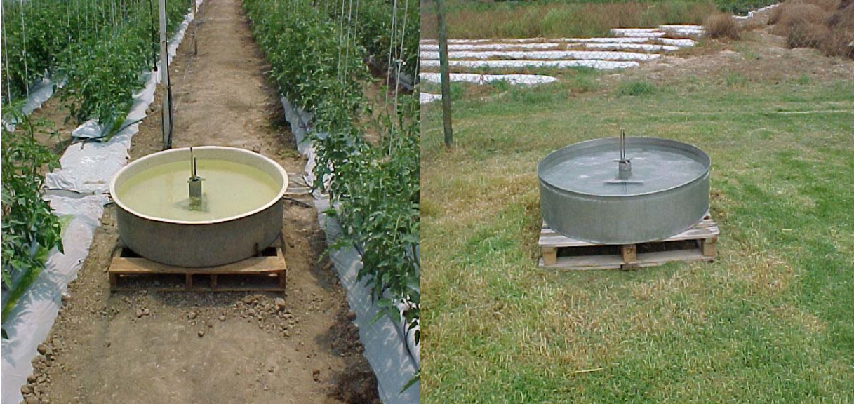
Figura 3.7. Tanque Evaporímetro Tipo "A" del Invernadero y de la Estación Meteorológica del CIQA respectivamente.
