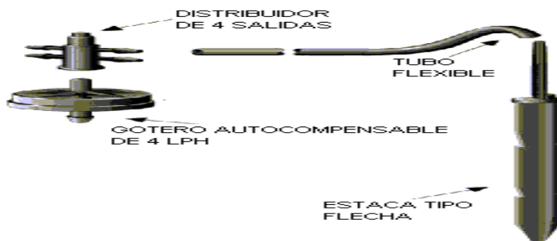
Figura 3.1. Gotero de 4 LPH, Distribuidor, Tubin y Estaca de gotero individual utilizados en la Producción de Tomate en Invernadero.
