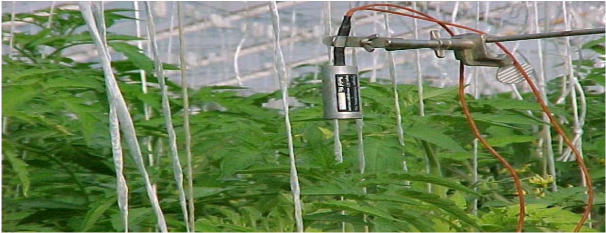
Figura 3.2. Arreglo del Sensor Infrarrojo para medir la Temperatura sobre una hoja a 5 cm de separación en una planta representativa del Invernadero.
