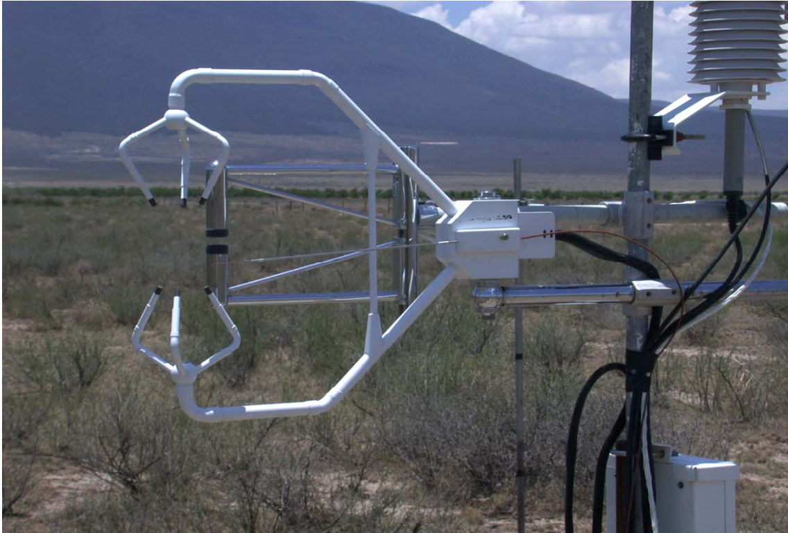
Figura 3.2. Elemento de una estación Eddy para medir flujos de calor sensible ( H ) y calor latente ( LE ), en el cual se muestra el 3-d anemómetro sónico, el termopar de alambre fino y el higrómetro de Kriptón de respuesta rápida.
