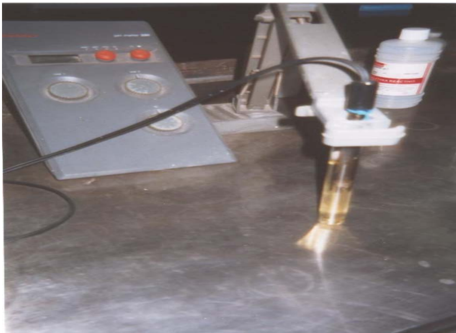
Figura 3.3.- Potenciómetro midiendo un pH de 7.81
