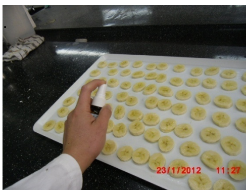
Figura 8. Aplicación de antioxidante Por aspersión
