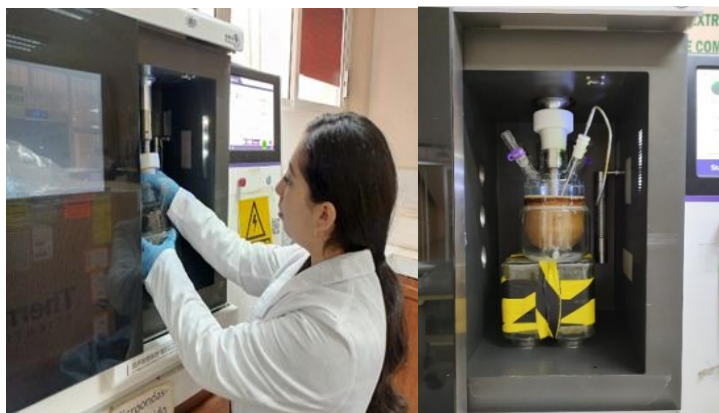
Figura 2. Tecnología Ultrasonido-Microondas aplicada en la obtención de extractos vegetales.
