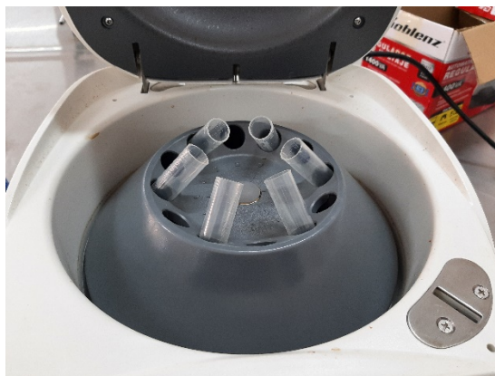
Figura 24. Centrifugación de las muestras para la Determinación de grados de amargor.
