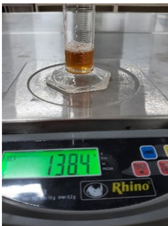
Figura 22. Determinación de densidad
