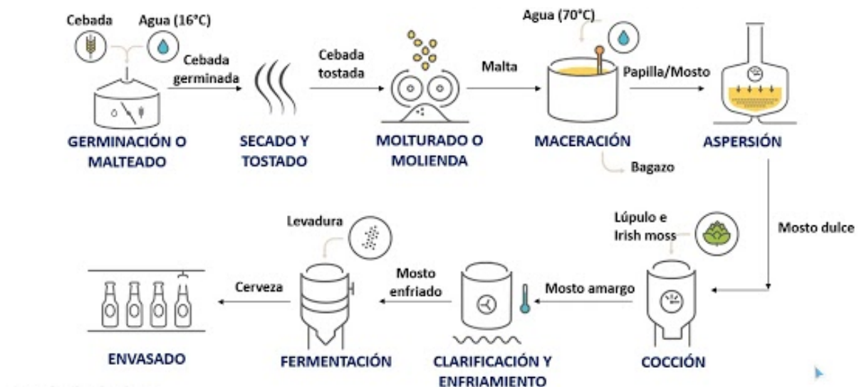
Figura 5. Proceso de elaboración de la cerveza artesanal
