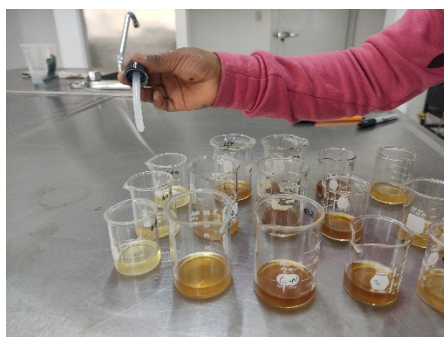
Figura 21. Determinación de acidez titulable
