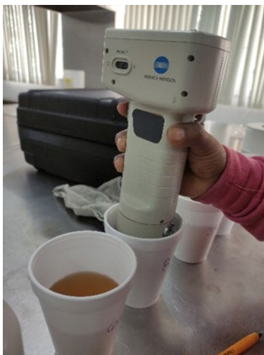
Figura 20. Determinación del análisis de color
