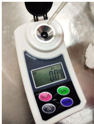
Figura 18. Determinación de sólidos solubles totales
