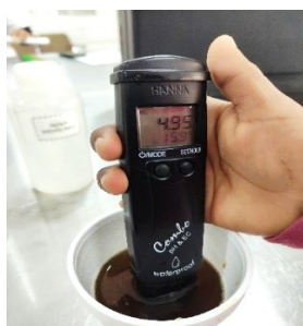
Figura 17. Determinación de pH
