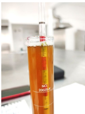
Figura 19. Determinación del porcentaje de alcohol.
