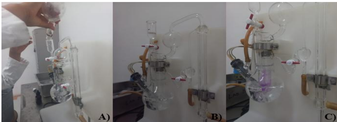
Figura 32. Aparato destilador Kjeldhal, A) Vertiendo solución NaOH, B) Calentando el reactivo, C) Destilación
