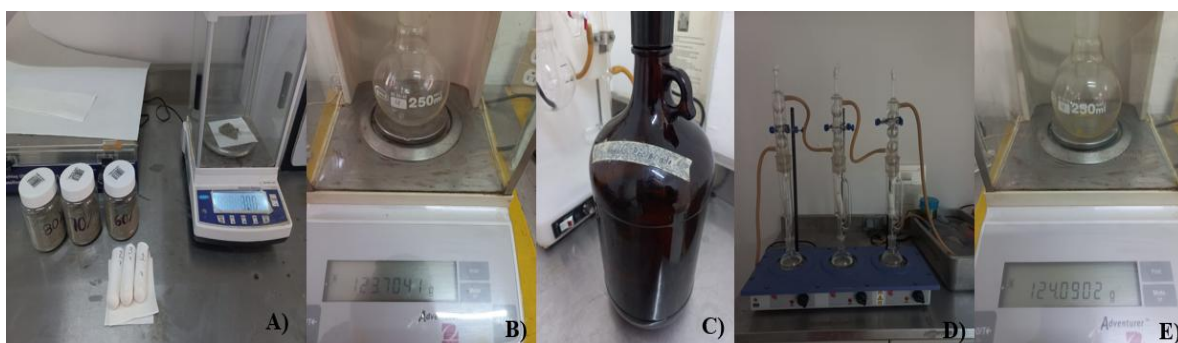
Figura 33. Procedimiento para determinar grasa; A) Se peso la muestra y se introdujo en cada embolo previamente identificados, B) Peso de los matraces bola fondo plano, C) Solución Éter, D) Aparato Soxhlet conectado a las muestras, E) Peso del matraz con grasa.
