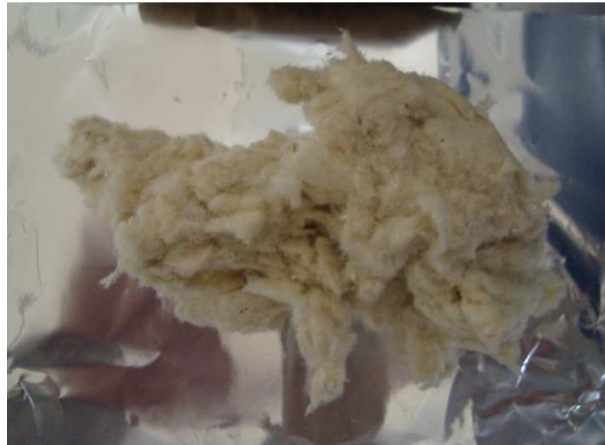
Figura 5. Plumas de ave lavadas, molidas y esterilizadas; condiciones necesarias para su utilización como sustrato.
