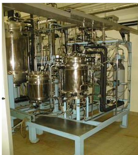
Figura 4. a) Fermentador piloto para escalamiento de procesos biotecnológicos y b) fermentación en medio sólido en charolas.
