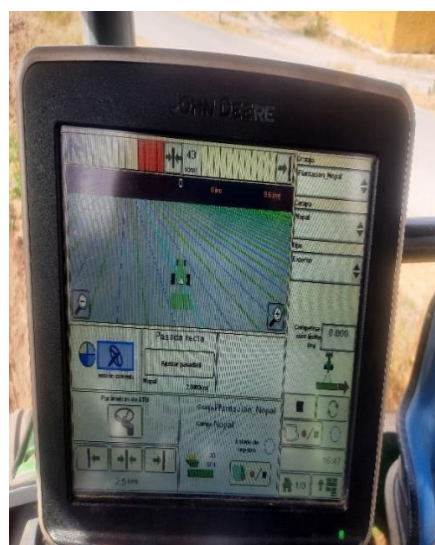
Figura 21. Sistema de dirección automática (fotografía ,2024)
