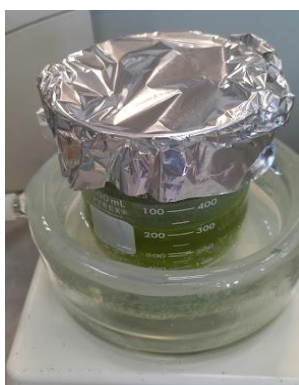
Figura 25. A) calentar 20 gr de muestra con etanol a una temperatura de 70^{\circ}\text{C} con un tiempo de 150 min, B) recolección de extracto ya centrifugado y purificado imágenes propias
