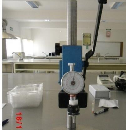
Figura 15. Penetrómetro FT-327
