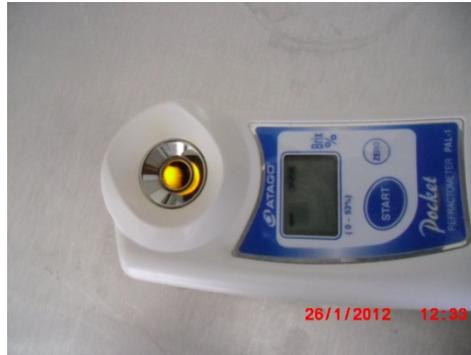
Figura 17. Refractómetro manual.
