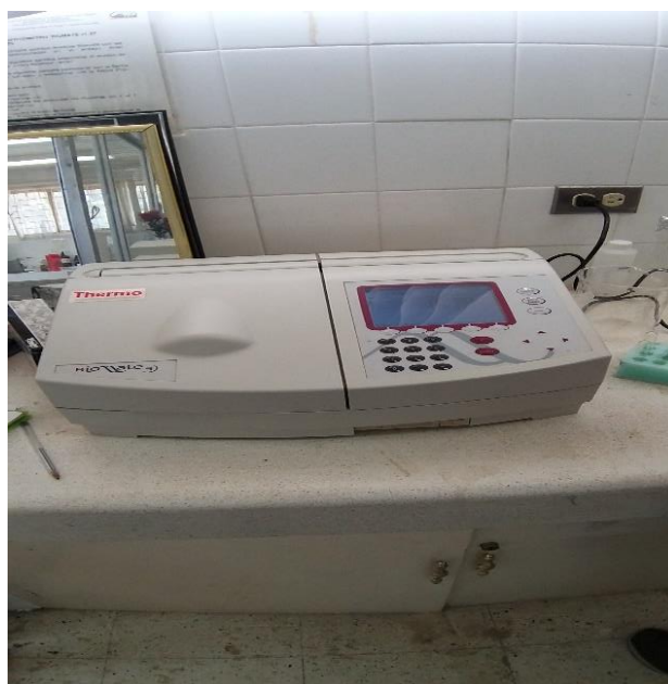
Figura 2. Determinación de P por espectrofotómetro UV-VIS
