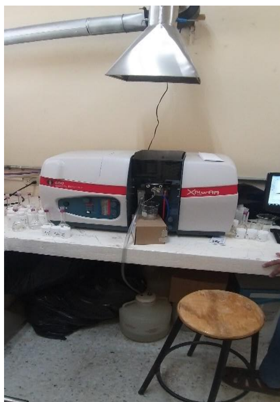
Figura 3. Determinación de K, Ca, Mg y Fe por espectrometría de absorción atómica.
