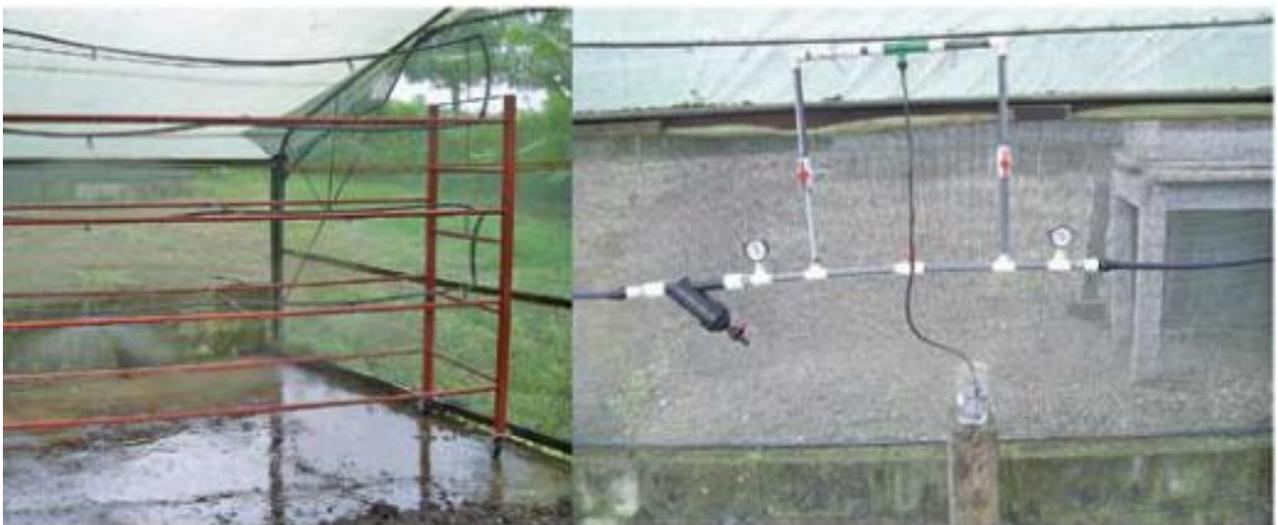
**Fig. 1,** Estantería para la producción de forraje verde hidropónico con el equipo de riego y el dosificador de nutrientes (Vargas, 2008).
