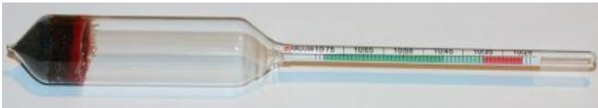
Figura 1. Calostrómetro (Tomado de Dairy Australia, 2012).
