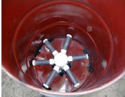
**Figura 38. Flautas instaladas dentro del filtro de barril.**
