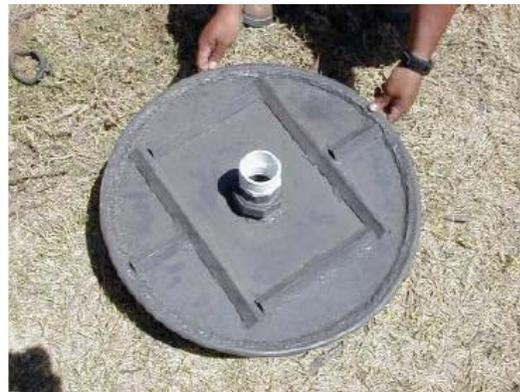
**Figura 41. Refuerzo de la tapadera del filtro de barril.**
