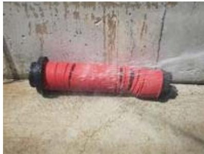
**Figura 19. Limpieza de anillas con un chorro a presión.**
