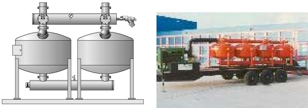
Figura 22. Instalación de Filtros de arena y sistema de estos Portátil.
