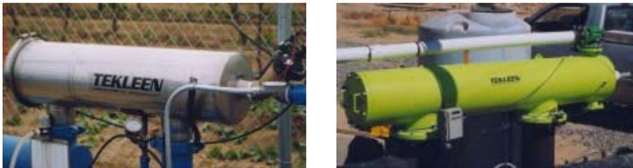
**Figura 59. Filtros Automatizados de mallas.**
