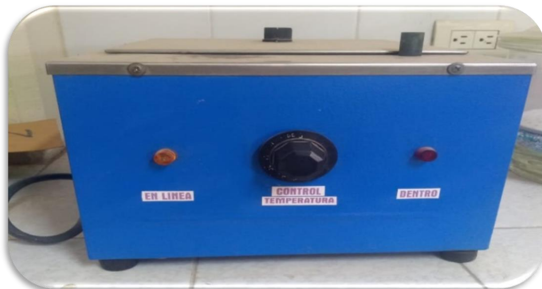
Figura 8.- Manejo del baño María, el aparato trabaja con agua destilada, la cual se agregará a la cámara con un volumen que sobrepase la parrilla en unos 4 cm. Las muestras se colocarán dentro del baño maría, el cual se enciende girando el control hacia la derecha y simultáneamente colocando a la temperatura que se desee trabajar, esperamos a que llegue a dicha temperatura, la cual se toma con un termómetro de alcohol o mercurio, una vez llegando a la temperatura requerida se apagara el indicador rojo y se comienza a tomar el tiempo necesario para efectuar el análisis
