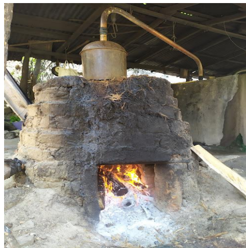
Figura 27. Destilación en alambiques de cobre.
