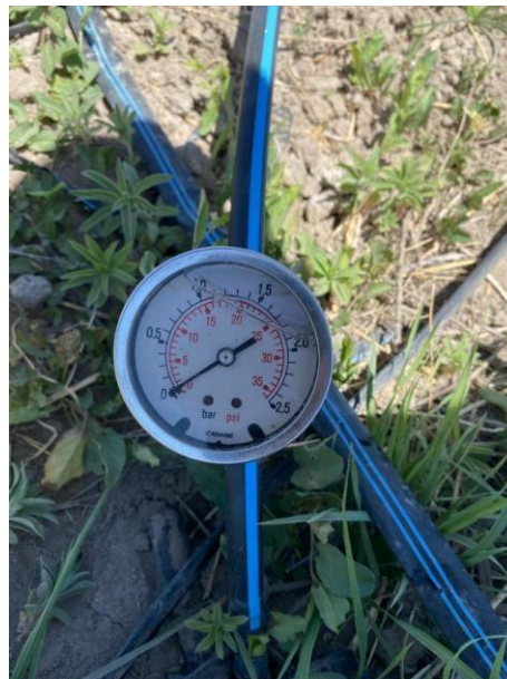
ILUSTRACIÓN 35 MEDICIÓN DE LA PRESIÓN AL INICIO DE LAS LÍNEAS REGANTES (FUENTE: ELABORACIÓN PROPIA)
