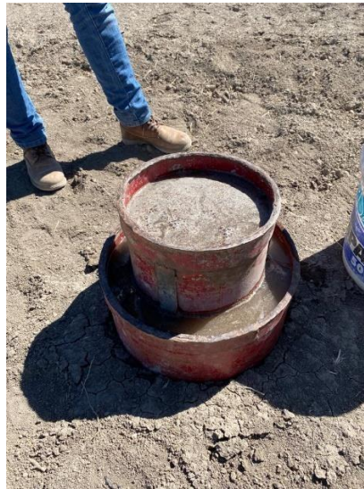
ILUSTRACIÓN 30 MÉTODO DE CILINDROS INFILTRÓMETROS (FUENTE: ELABORACIÓN PROPIA)
