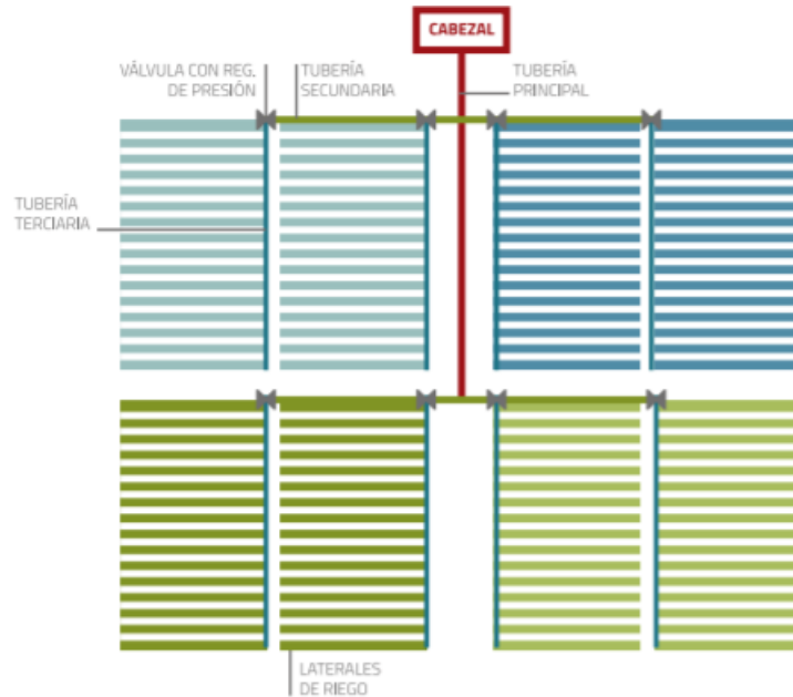
ILUSTRACIÓN 4 SISTEMA DE RIEGO PRESURIZADO (PROSAP, 2015)
