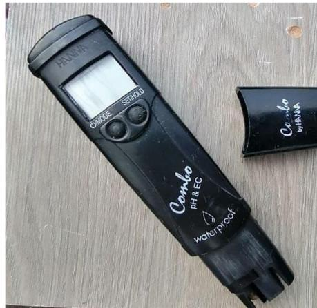
**Figura 3** Medidor pH y CE marca HANNA
