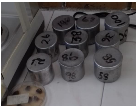
Figuras 3.10. y 3.11. Determinación de peso seco.
