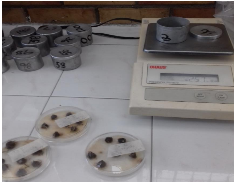
Figura 3.5. Proceso para llevar a cabo el peso seco en la balanza analítica.
