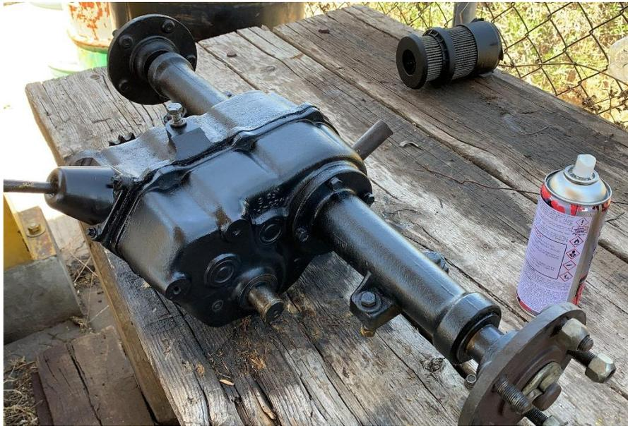
**Figura 24. Caja de velocidades armada y detallada.**
