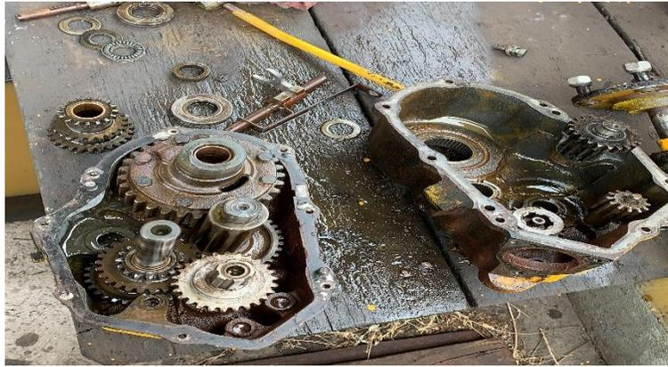
**Figura 22. Limpieza de las partes internas de la caja de cambios.**
