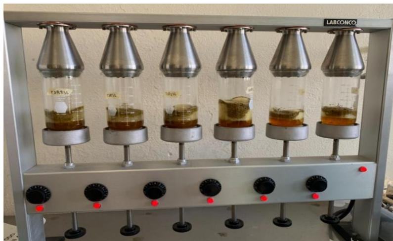
**Figura 10.** Proceso para la determinación de fibra cruda.
