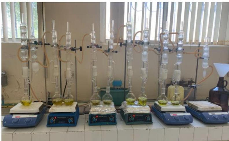
**Figura 9.** Proceso para la determinación de extracto etéreo.
