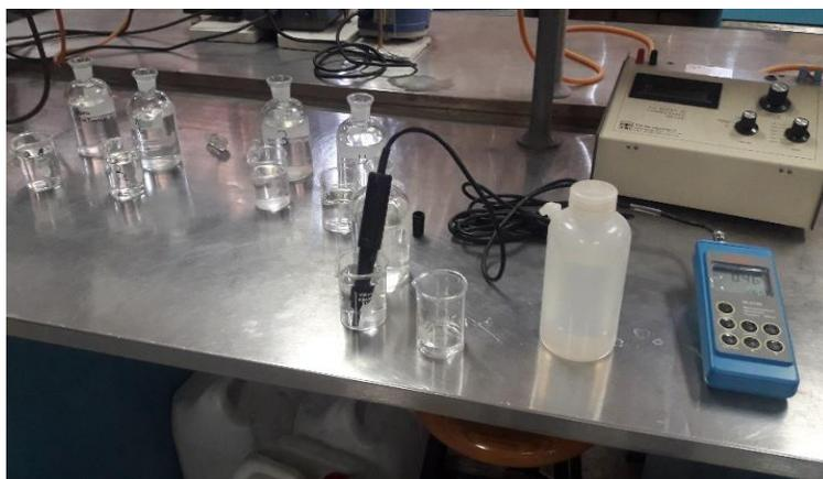
Figura 13. Medición de Oxígeno disuelto en muestras.
