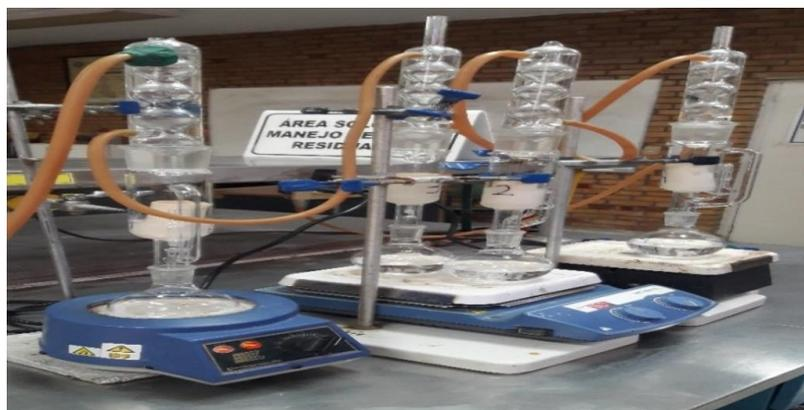
Figura 16. Soxhlet utilizado para determinar G y A.
