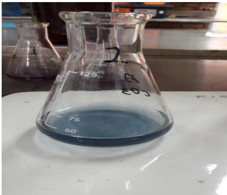
Figura 20. Titulación para obtención de Magnesio
