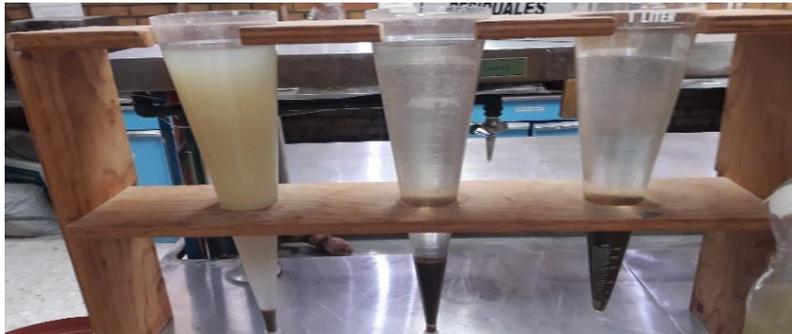
Figura 6. Determinación de Sólidos Sedimentables (SS).
