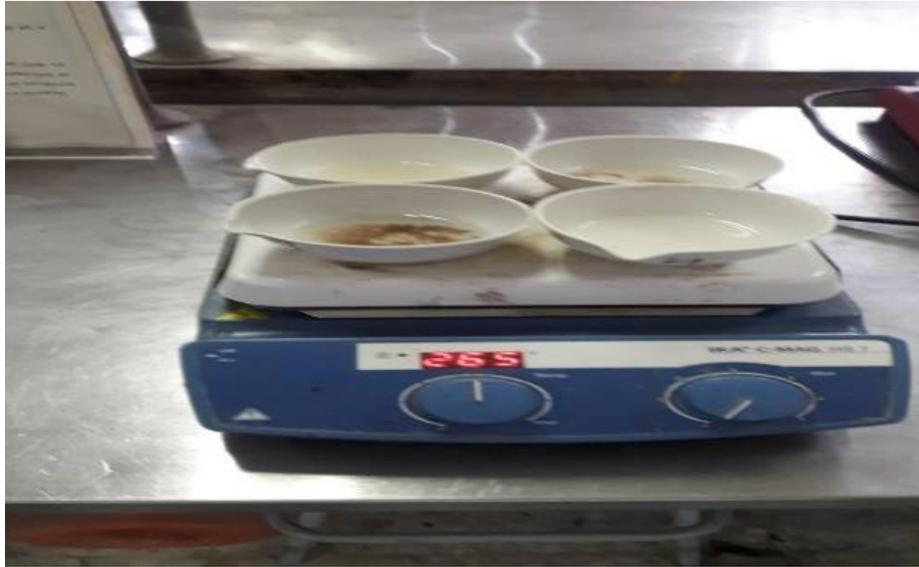
Figura 8. Evaporación de la muestra para su determinación de ST.y STV.
