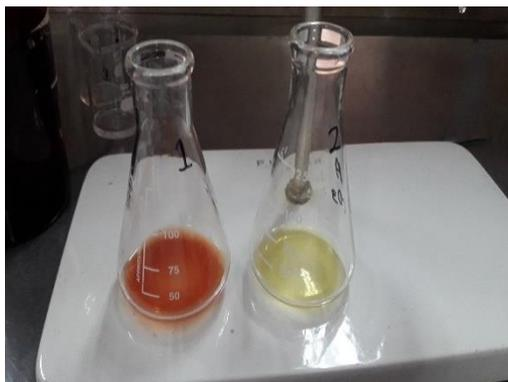
Figura 22. Obtención de Cloruros (NMX-AA-073-SCFI-2001)
