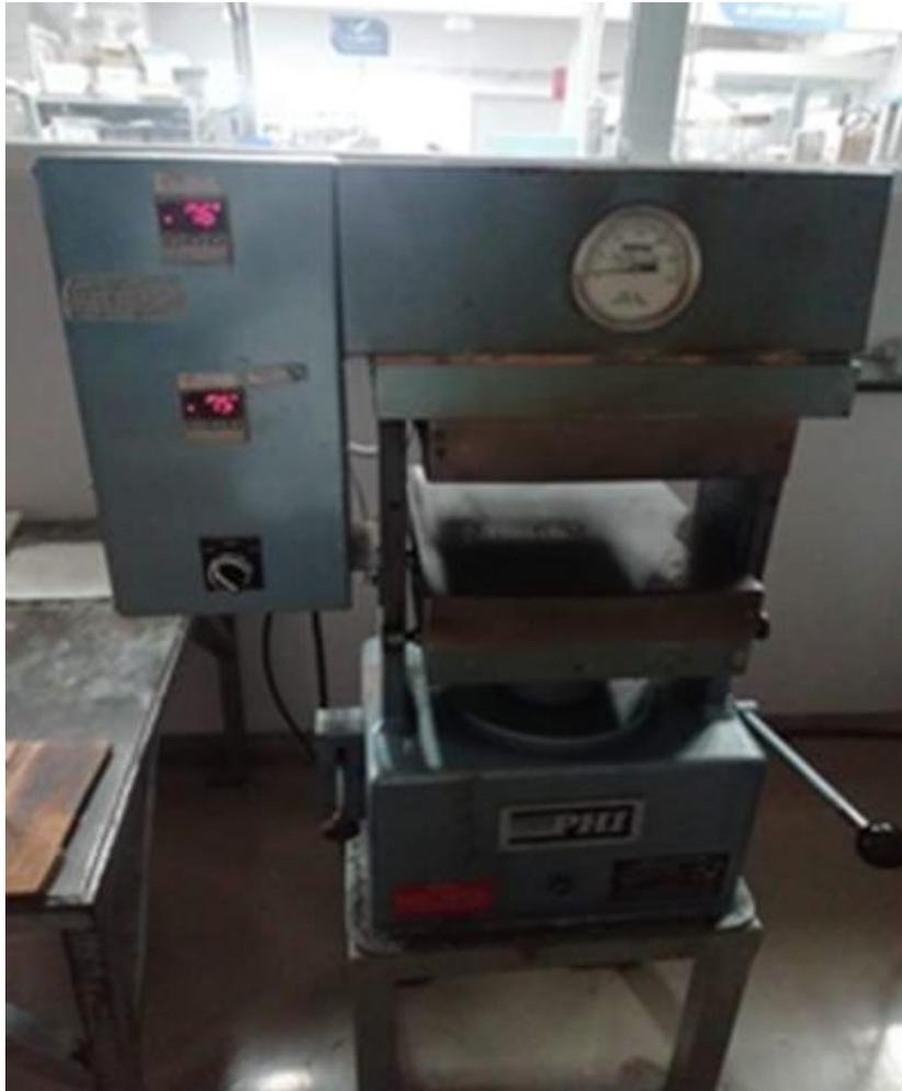
**Figura 12** Termoconformadora
